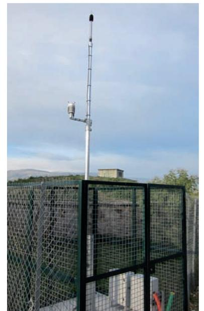
Capteur de mesure de bruit
