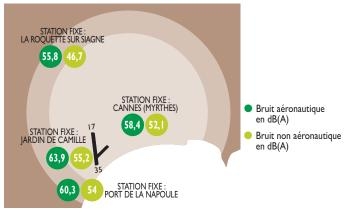
Le bruit aéronautique mesuré pour les stations de La Napoule et du jardin de Camille est plus important que pour les autres stations (60,3 dB et 63,9 dB) car elles mesurent le bruit des décollages des avions, le décollage étant la phase de vol la plus bruyante.
